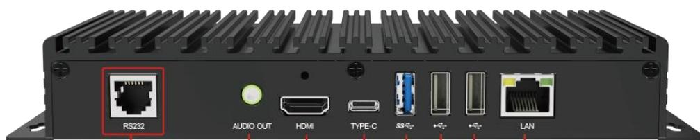
UART 接口    3.5mm音频输出    连接电脑, 设置显示屏参数, 发布节目    USB 2.0, 接USB摄像头、U盘    千兆网口    USB 2.0, 接USB摄像头、U盘    与外部设备进行通讯
