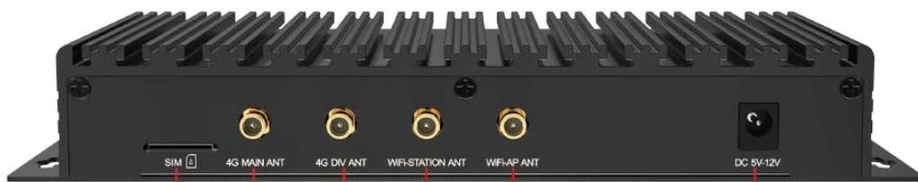
Micro-SIM卡槽    外接4G主天线    外接4G副天线    外接WiFi天线    外接WiFi天线    DC 5V-12V 电源输入
