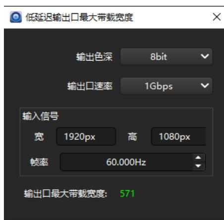
图 4.3-5 低延迟网口最大带载宽度
