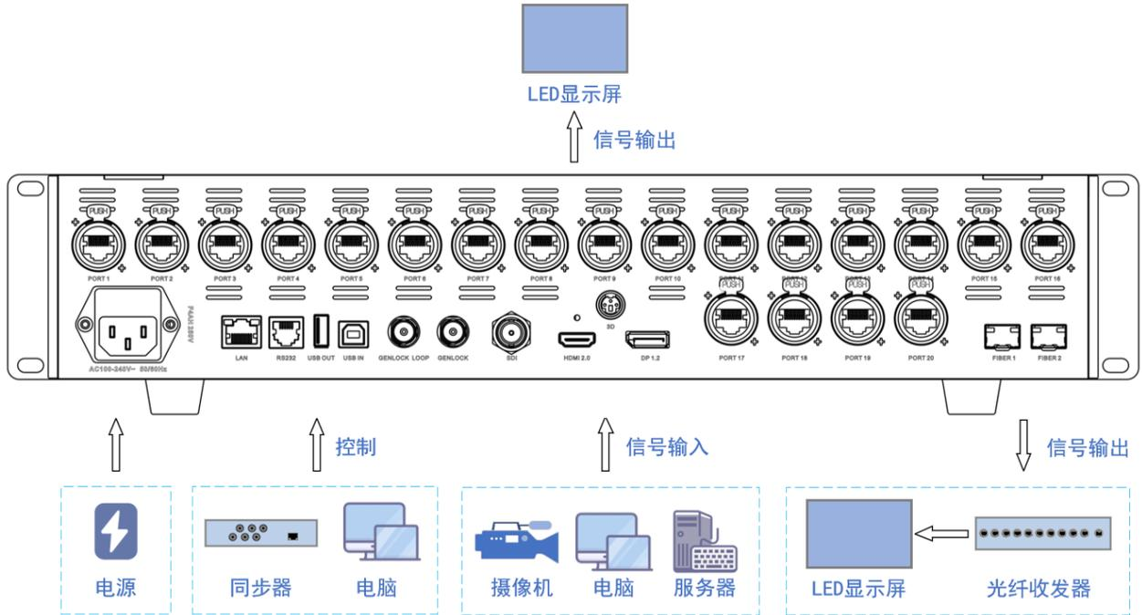
网口输出：选择网口输出时，网口通过网线直接连接至 LED 显示屏。
