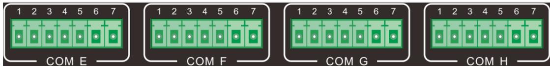
本主机共有 4 个 7PIN 的可编程双向复合串行端口，支持 RS-232、RS-422 或 RS-485 通讯协议，传输速率最高可以达到 115200bps，支持 2400~115200bps 间的七种标准速率。(参见“Logic Master 1.5.2”开发软件)
