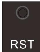
设备上电 30 秒左右压住此键持续约 5 秒钟，系统自动恢复出厂设置状态，IP 地址恢复为出厂设置的 192.168.0.111。复位设置成功时，前面板 STA 指示灯闪烁五次。
