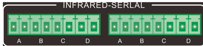
集成控制主机共有 8 组端口，每一组都可以作为红外端口输出或单向 RS-232 输出，每组两个 PIN 左边为信号正、右边为信号地。红外输出的载波频率最高可达 1.2MHz，数据传输速率可以达到 115K 每秒。单向 RS-232 端口输出的幅度为 TTL 电平水平，即 0 至+5V 范围，这可能不适合某些串行受控设备。
