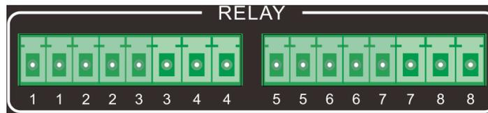
8 个低压继电器端口，常开触点，每组相互独立并隔离，每组最大可以承载 2A 32V AC/DC 负载。
