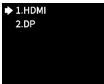
进入“HDMI”或“DP”的分辨率调节界面（以 HDMI 为例）。在常规分辨率中，可通过旋钮选择常规分辨率，按旋钮/OK 键将选择的分辨率保存到发送器；在自定义分辨率中，可通过旋钮自定义分辨率的宽度、高度和帧率，并将其保存到发送器。
