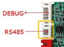
1组485通讯接口，可支持市面上通用的485 接口设备，接口的电平为5V。如果对接的接口的电平高于5V 时，要有隔离电路或者电平转换电路，否则会烧坏主控和设备。
