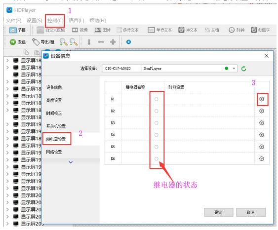
2. 点击 设置按钮进入时间设置界面,设置端口 K1-K6 的时间。
