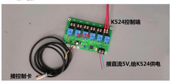
2. K524 与电流接触器的连接
