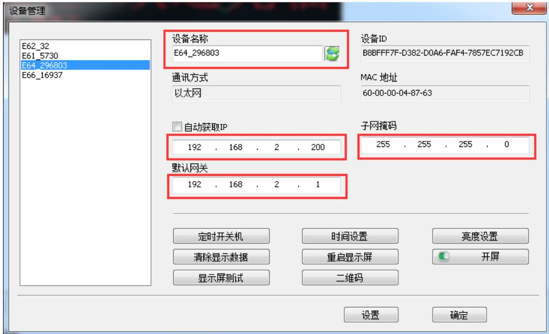
2.IP 地址修改好了之后，在软件中新建显示屏，且屏参设置时绑定设备名称，有多少个卡软件中新建多少个显示屏。
