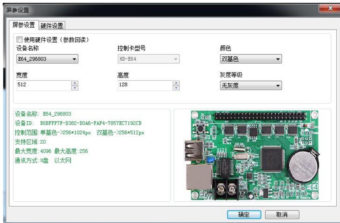
控制卡中已有正确参数的（正常显示文字），勾选“使用硬件设置”，选择设备，点击确定，完成一个显示屏的建立。
