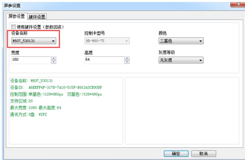
当前显示屏显示不正常的情况下，在硬件设置界面设置智能设置参数，如果当前显示屏显示正常，不需要进入硬件设置界面设置。（常规屏只需要选择常用智能设置，非常规的可以进行智能设置）
