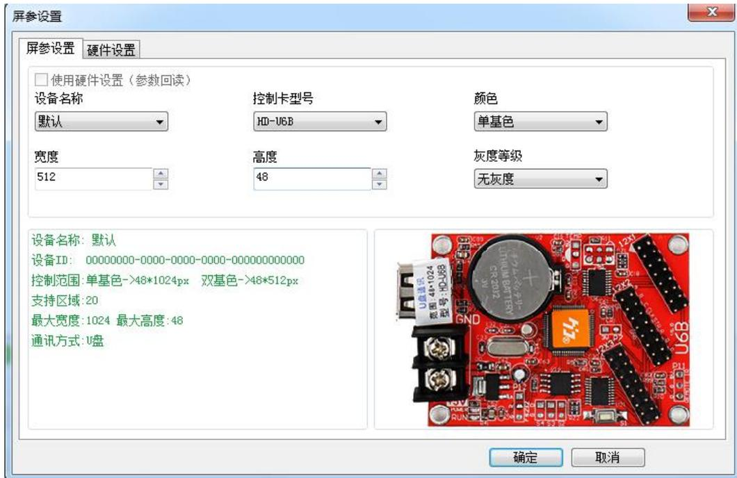
2. 设置硬件设置参数。(当前显示屏显示正常的情况下，不用设置此界面)
