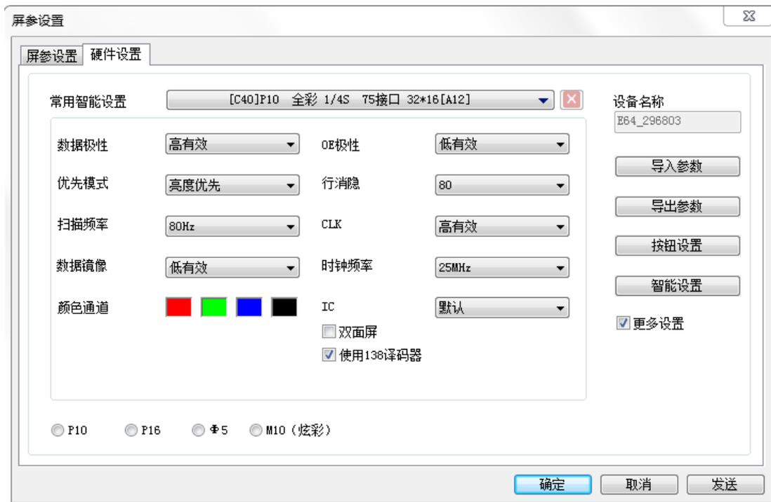
按钮设置在硬件设置界面，用于调整四个按键的功能，入下图所示：
