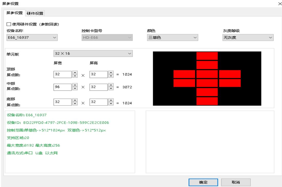
十字屏可以建立全局节目和节目，全局节目是顶部、中部、底部为整体显示一个区域的节目，建立节目可以分三个区显示节目。
