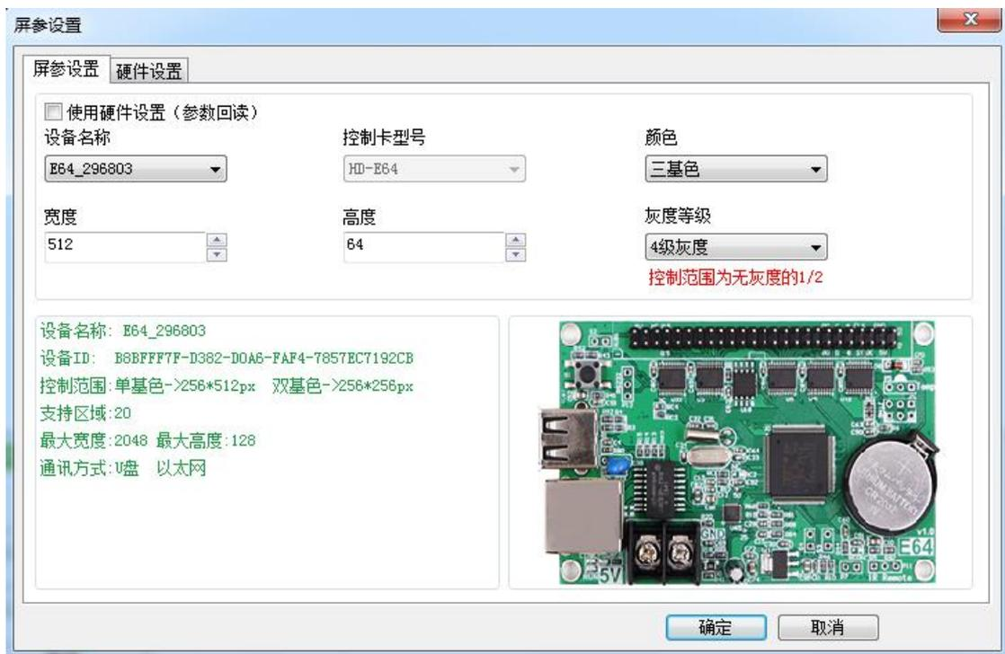
b. 进行智能设置，在常用的智能设置中，如果有您当前使用的单元板的参数，可以直接选择，然后点击发送，如下图所示：
