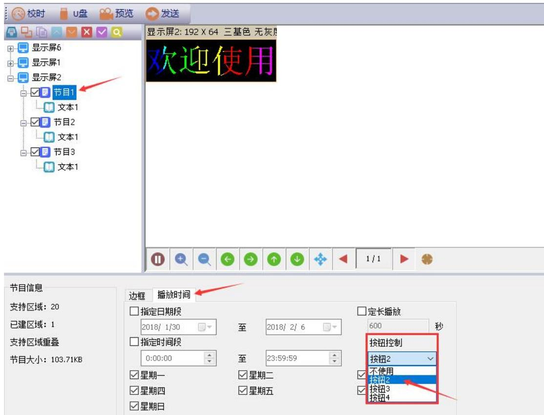
定时关机:设置控制卡的开屏和关屏时间。
