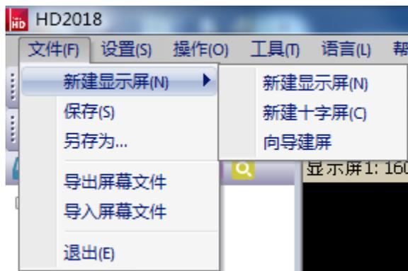
**新建显示屏 (Ctrl+N)** :用于新建一个显示屏，HD2018 可管理屏没有限制，也可分组管理（在系统设置中“添加组”打钩）；
