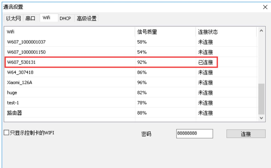
Wi-Fi 连接上之后，**在软件中即可以找到设备**。如图所示：信息窗口在线栏会出现控制卡的设备名称等信息。
