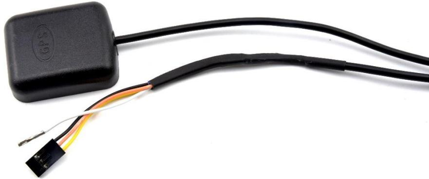
目前支持连接 GPS 传感器的单双色控制卡有 E62、E62+、E63、E64、E66、W60-75、W63、W64、W66、S63、U60-75、U60+、U62+、U63、U64。实物连接如下:
