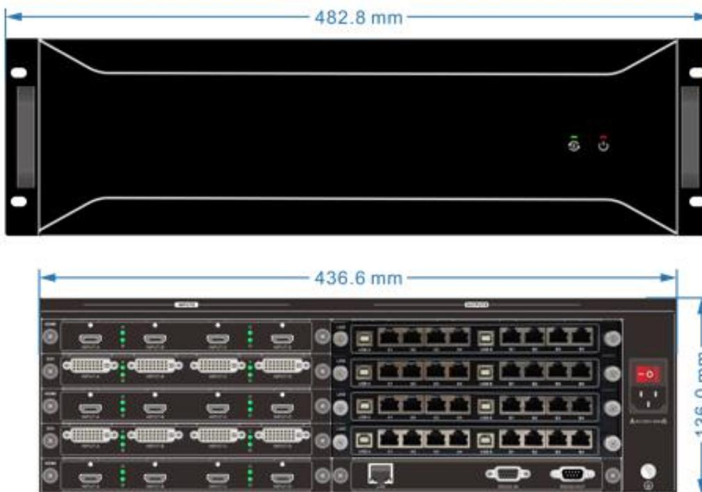
36x72 混合处理器：W436.6mm x H269.0mm x D320.0mm：
