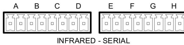
7PIN 的可编程双向复合串行端口，红外串行输出端口，I/O 端口，低压继电器端口的连接 3.5mm Phoenix 端子出厂提供。
