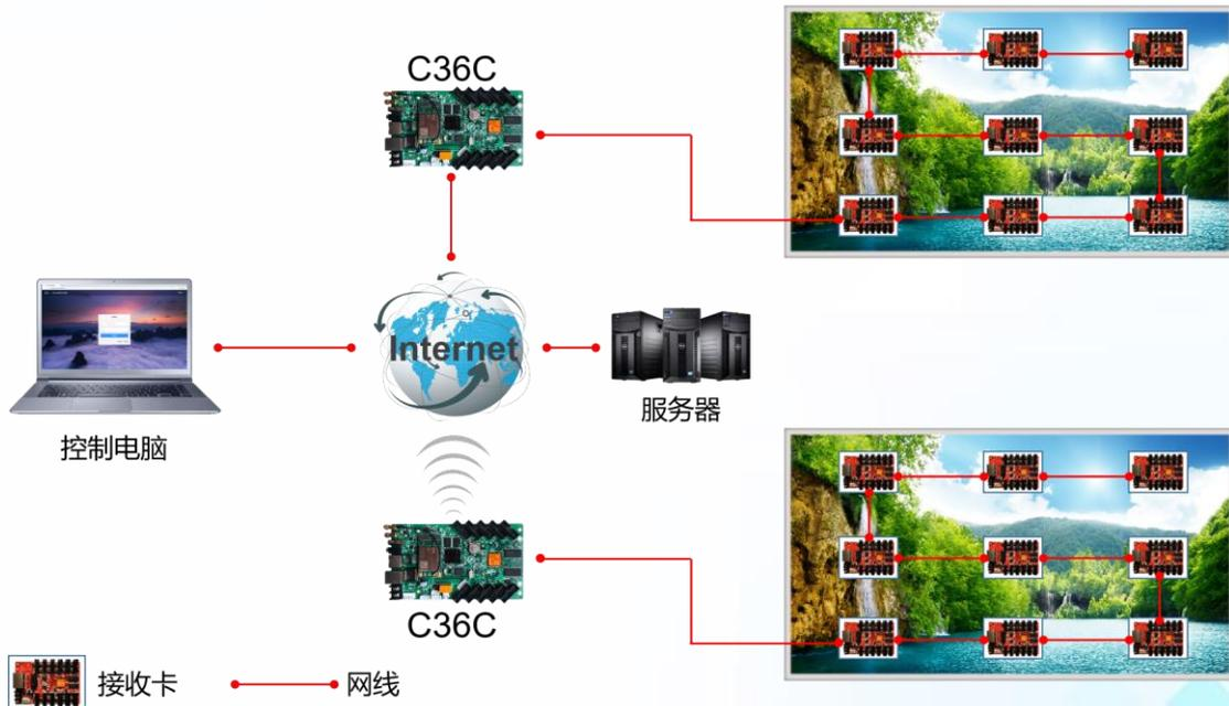
2. 异步一对一控制：通过网线连接、Wi-Fi 连接和 U 盘的方式更新节目。局
