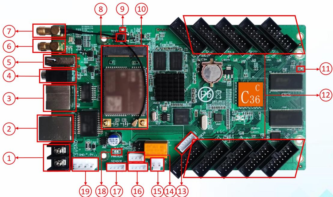
1. 电源接线柱：5V直流电源输入；
