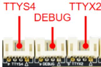
1 组普通双绞串口，可支持市面上通用的串口设备，串口的电平为 0V 到 3.3V。如果对接的串口的电平高于 3.3V 时，要有隔离电路或者电平转换电路，否则会烧坏主控和设备。
