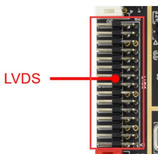
通用的 LVDS 接口定义，支持单/双，6/8/10 位 1080P LVDS 屏。屏电压可以通过跳线帽进行选择，可选择支持 3.3V/5V/12V 屏电源供电。
