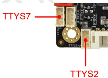
板卡引出了一组普通 UART 串口，可支持市面上通用的 UART 串口设备。
