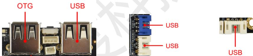
板卡具有 2 个 USB 标准接口（自定义 OTG），3 个内置的 USB 插针，用于外设扩展 USB 接口。
